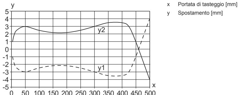
Comportamento di risposta tip. (distanza di regolazione 1200 mm)
