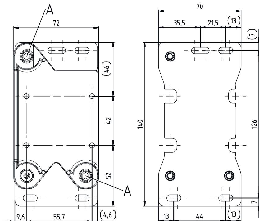
A Vis d'ajustage avec six pans creux, clé de 4
