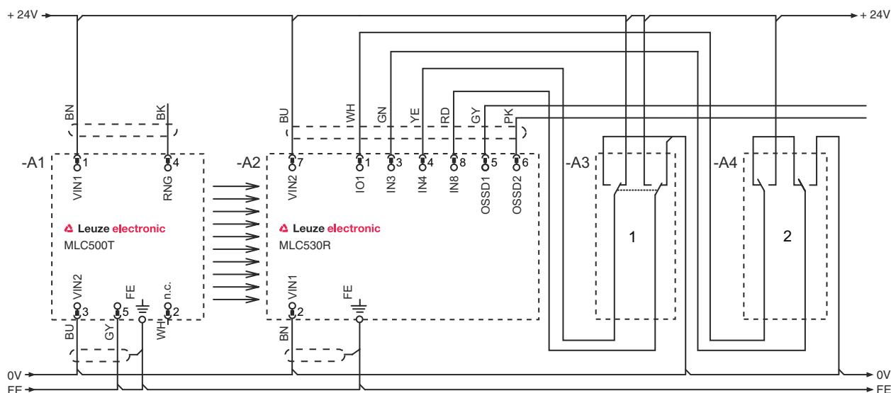
1 Interruptor de chave inversor para alternar entre os grupos funcionais FG1 e FG2
