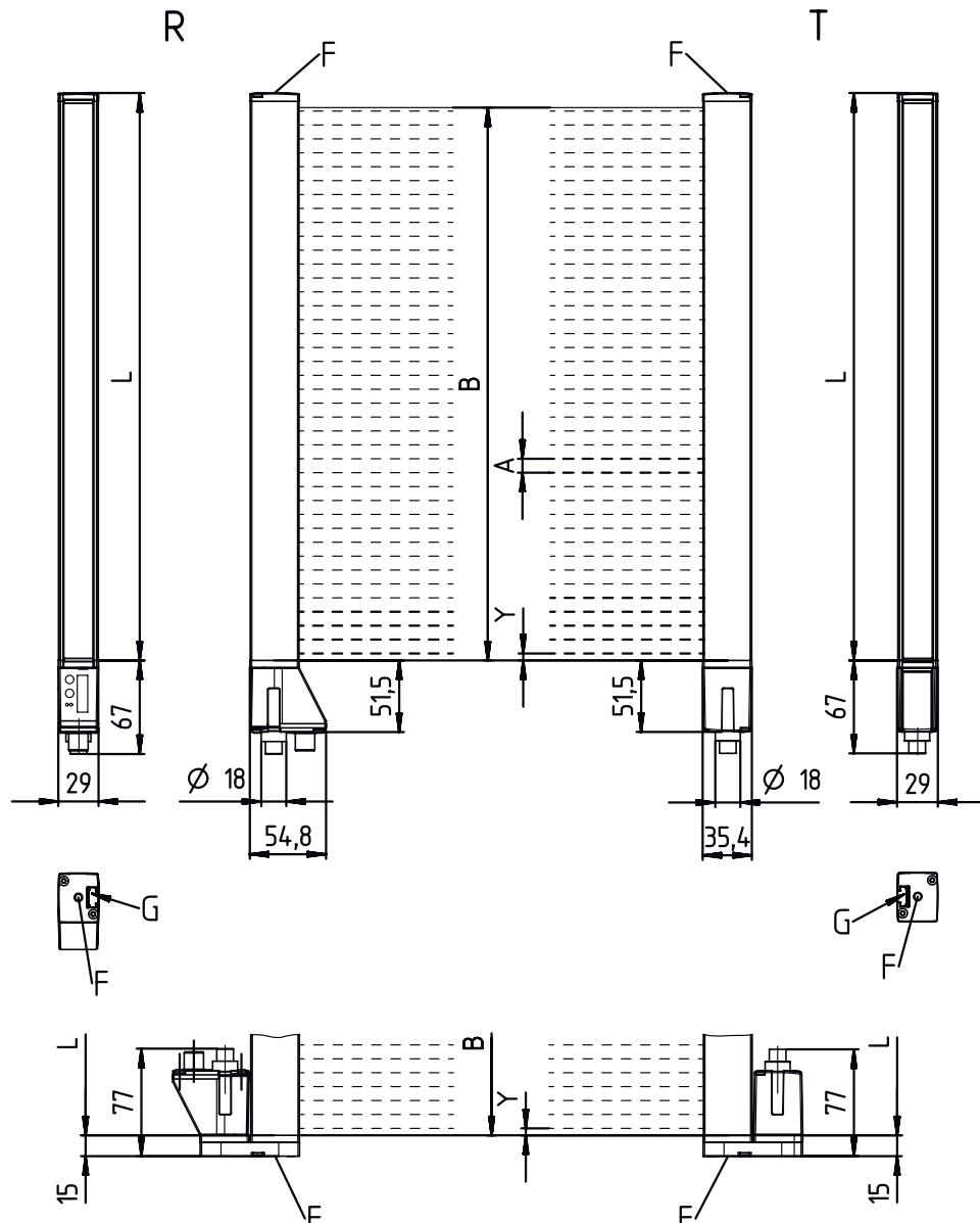
A Intervalle entre les faisceaux 20 mm
