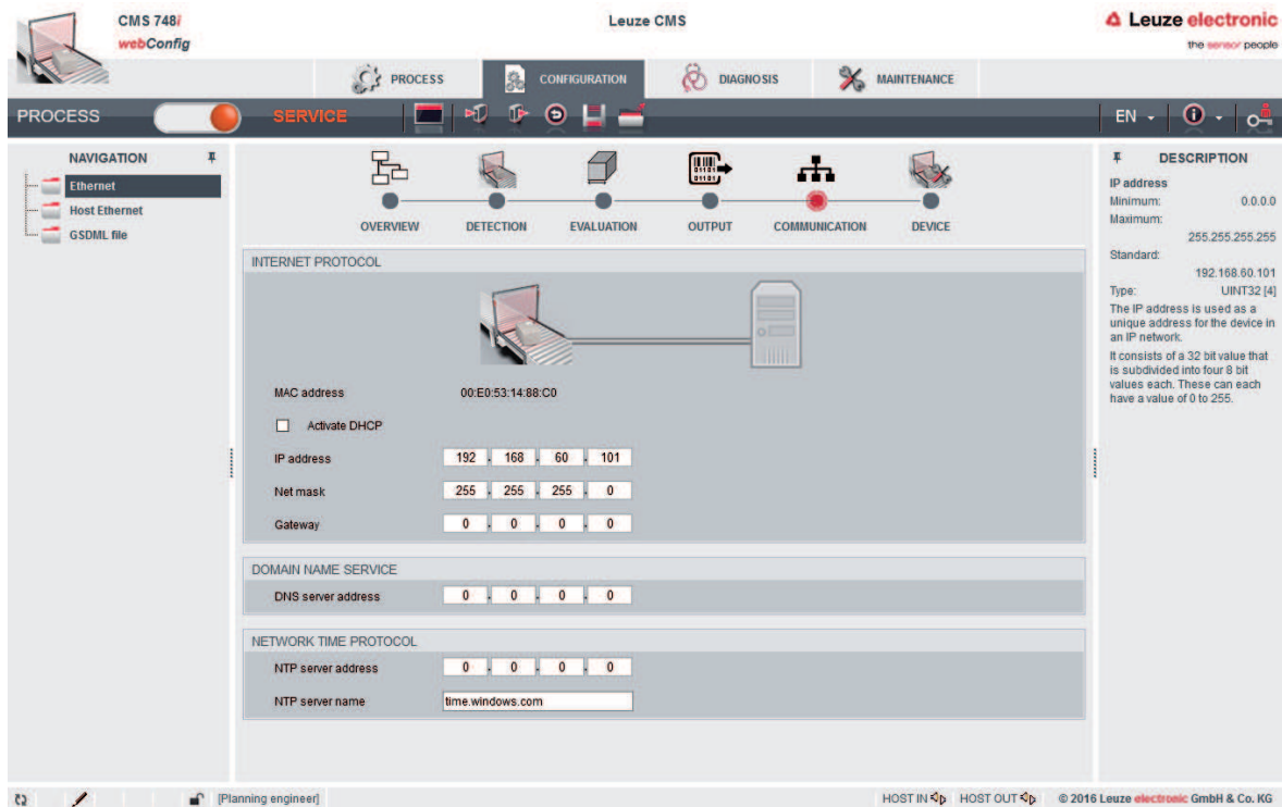
Figura 8.10: Configurazione dell'interfaccia Ethernet
