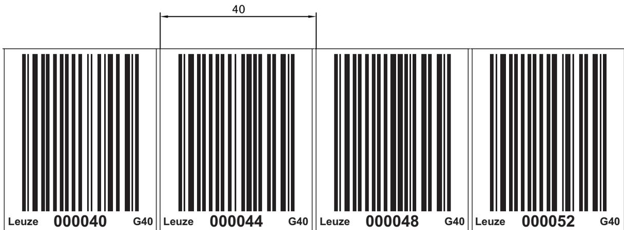
Bild 10.1: Überprüfen des Druckergebnisses BCB G40 ...-Reparaturkit (40 mm Raster)
