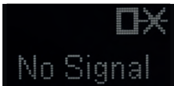
Bild 8.7: Anzeige: kein Messwert bei Deaktivierung
