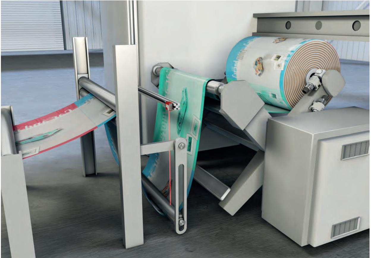
Fig. 4.4: Mesure de tirant
