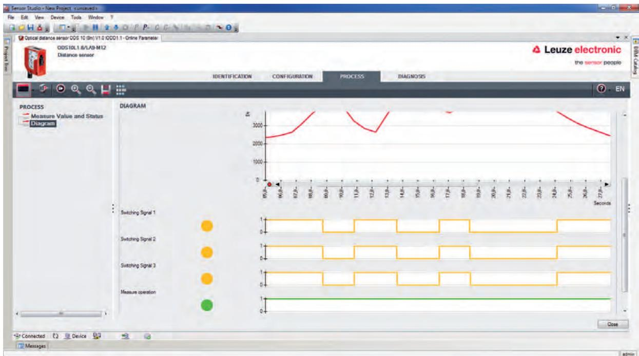
Fig. 8.11: Fonction *PROCESSUS* – Représentation des valeurs mesurées
