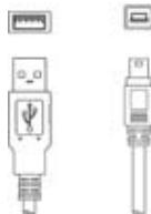
50117011 | KB USB A - USB miniB | Ligne de maintenance | Adapté pour interface: USB<br>Connexion 1: USB<br>Connexion 2: USB<br>Blindé: Oui<br>Longueur de câble: 1.500 mm<br>Matériau de gaine: PVC |
