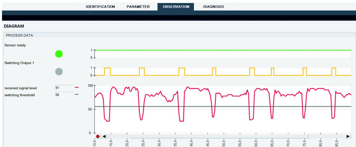
Die einfache Visualisierung der Prozessdaten in der PC-Parametriersoftware Leuze Sensor Studio ermöglicht eine schnelle Beurteilung der Prozessstabilität.
