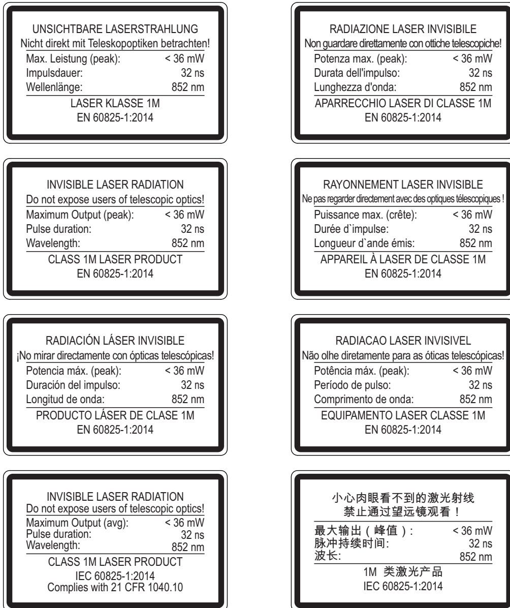
图 2.3: 频率为 F4 的设备的激光说明标牌
