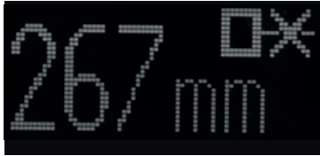
Bild 8.6: Anzeige: Messwert eingefroren bei Deaktivierung
