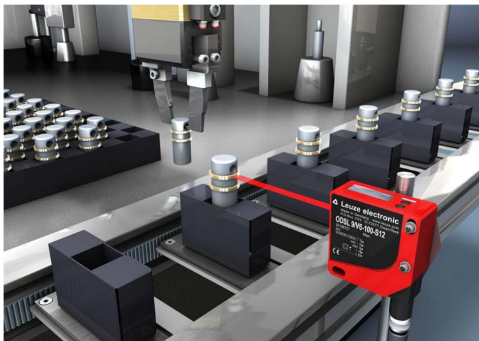
Fig. 4.2: Exemplo de aplicação: controle de montagem
