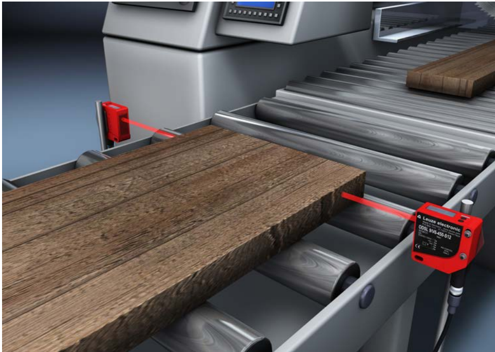
Fig. 4.1: Exemplo de aplicação: medição da largura de madeira
