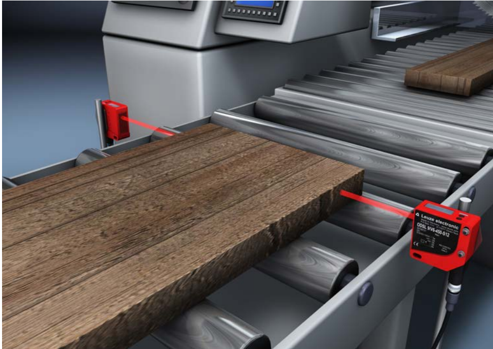
Figura 4.1: Esempio applicativo: misura della larghezza del legno
