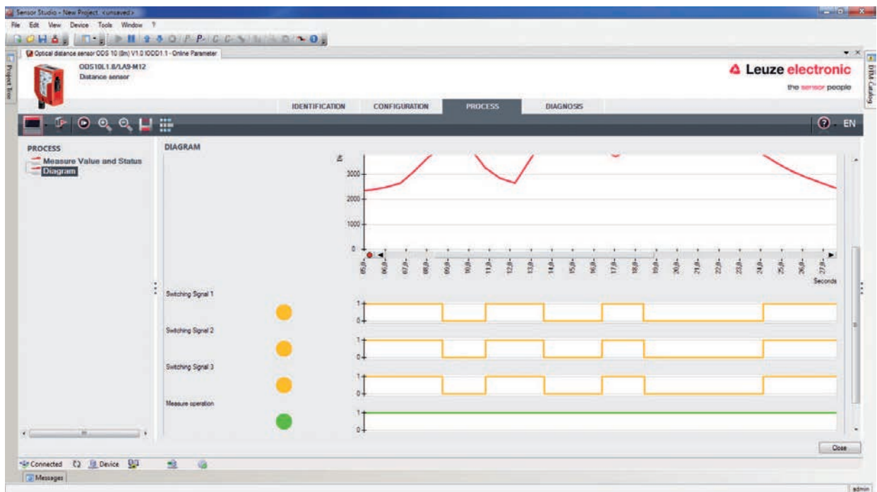
Fig. 8.11: Fonction PROCESSUS – Représentation des valeurs mesurées
