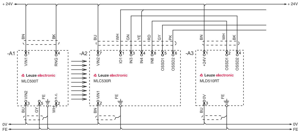
Modo de funcionamiento 3: ejemplo de circuito con un interruptor de posición por contacto encadenado para supervisar el objeto enmascarado y un conmutador para comutar entre los grupos de funciones FG1 y FG2
