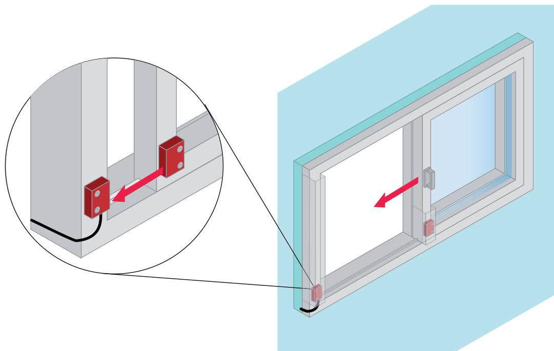
图 6.3: 在同一平面上启动操作钥匙
