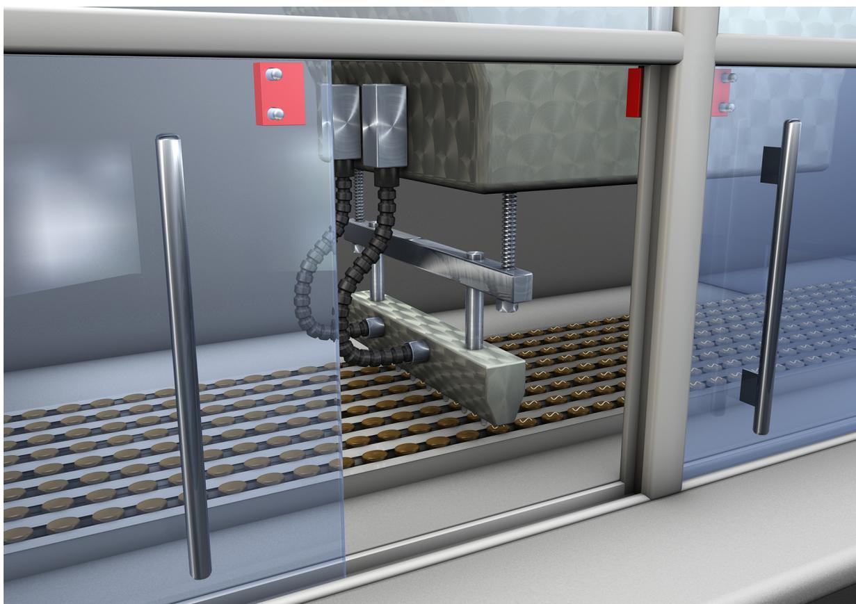
图 5.4: 滑门上的 MC336x 传感器执行食品生产线使用安全措施
