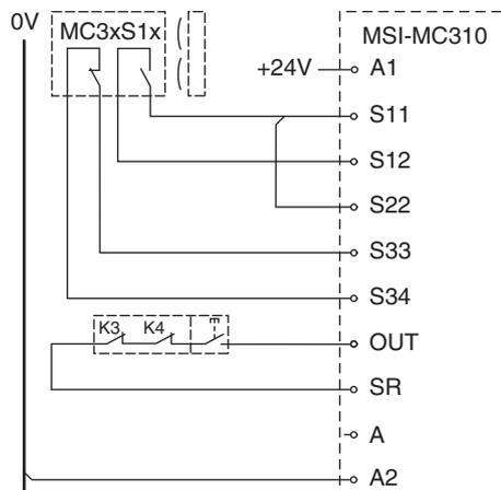
图 7.10: 例 1：带启动 / 重启联锁装置及接触器监控 (EDM) 的 MC3xS1x 双通道线路连接，无操作钥匙激活触点显示
