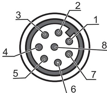
图 7.9: M12-圆连接器的引脚分配 (8 针)
