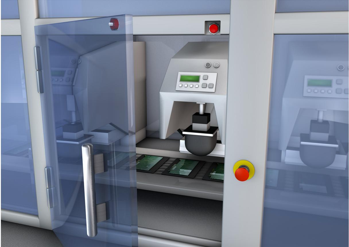
图 5.1: 门上的 MC330x 传感器，作为一条 LP 生产线上的通道保护装置
