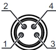
图 7.3: M8- 圆形插塞连接器的引脚分配
