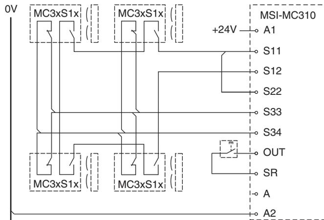
图 7.12: 例 3: 配有启动 / 重启联锁装置的的 4 个 MC3xS1x 线路，无操作钥匙激活的触点显示
