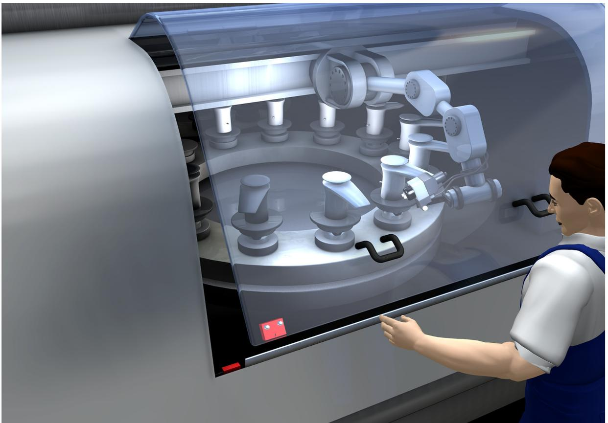
图 5.3: 顶罩上的 MC336x 传感器，作为小喷漆机器人的防侵入保险
