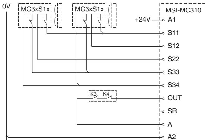
图 7.11: 例 2：带自动启动 / 重启及接触器监控 (EDM) 的两个 MC3xS1x 的连接，无操作钥匙激活触点显示
