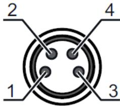
图 7.7: M8-圆连接器的引脚分配 (4 针)
