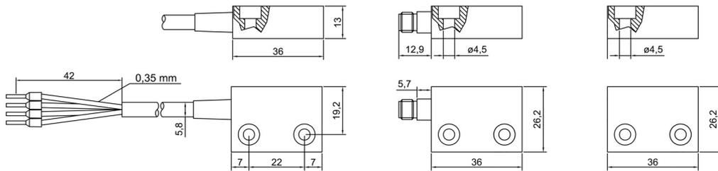
图 15.2: MC336x 传感器和操作钥匙尺寸
