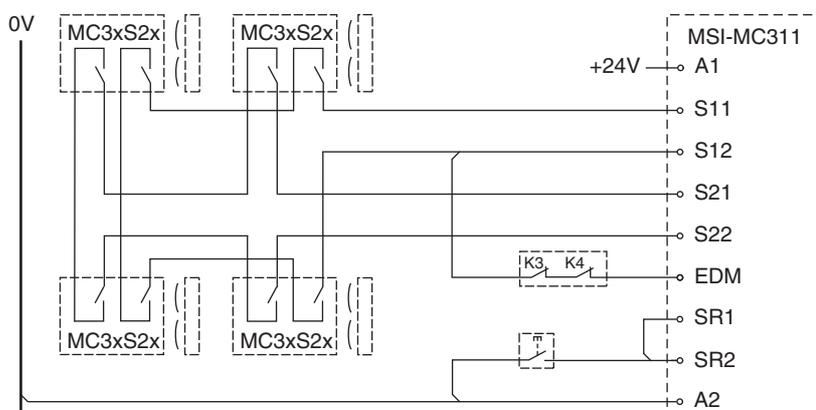
图 7.16: 例 3: 配有启动 / 重启联锁装置的 4 个 MC3xS2x 线路，无操作钥匙激活的触点显示
