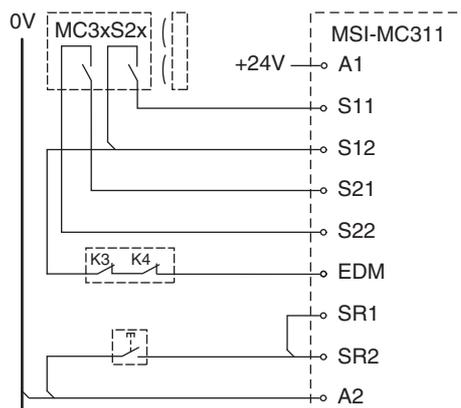
图 7.14: 例 1：带启动 / 重启联锁装置及接触器监控 (EDM) 的 MC3xS2x 双通道线路连接，无操作钥匙激活触点显示
