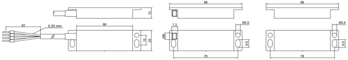
图 15.1: MC388x 传感器和操作钥匙尺寸
