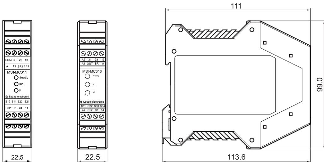
图 15.4: MSI-MC310/MSI-MC311 安全继电器尺寸
