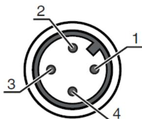
图 7.4: M12- 圆形插塞连接器的引脚分配
