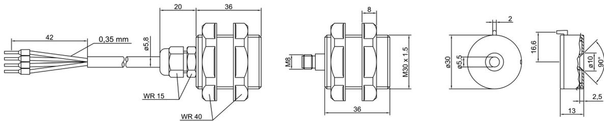
图 15.3: MC330x 传感器和操作钥匙尺寸
