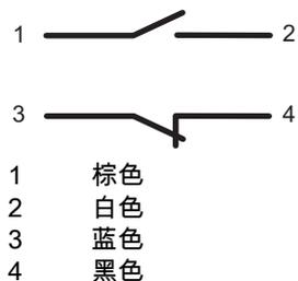
图 7.2: 连接电缆的芯线分配, 颜色, 不通过操作钥匙激活的状态
