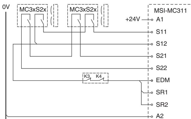
图 7.15: 例 2：带自动启动 / 重启及接触器监控 (EDM) 的两个 MC3xS2x 的连接，无操作钥匙激活触点显示
