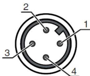
图 7.8: M12-圆连接器的引脚分配 (4 针)
