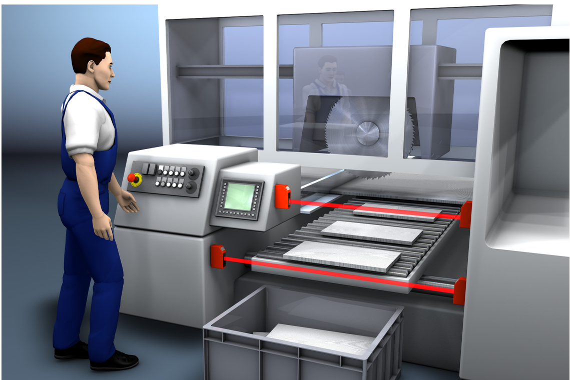
图 5.2: 锯木机通道保险装置 / 安全防护设备
