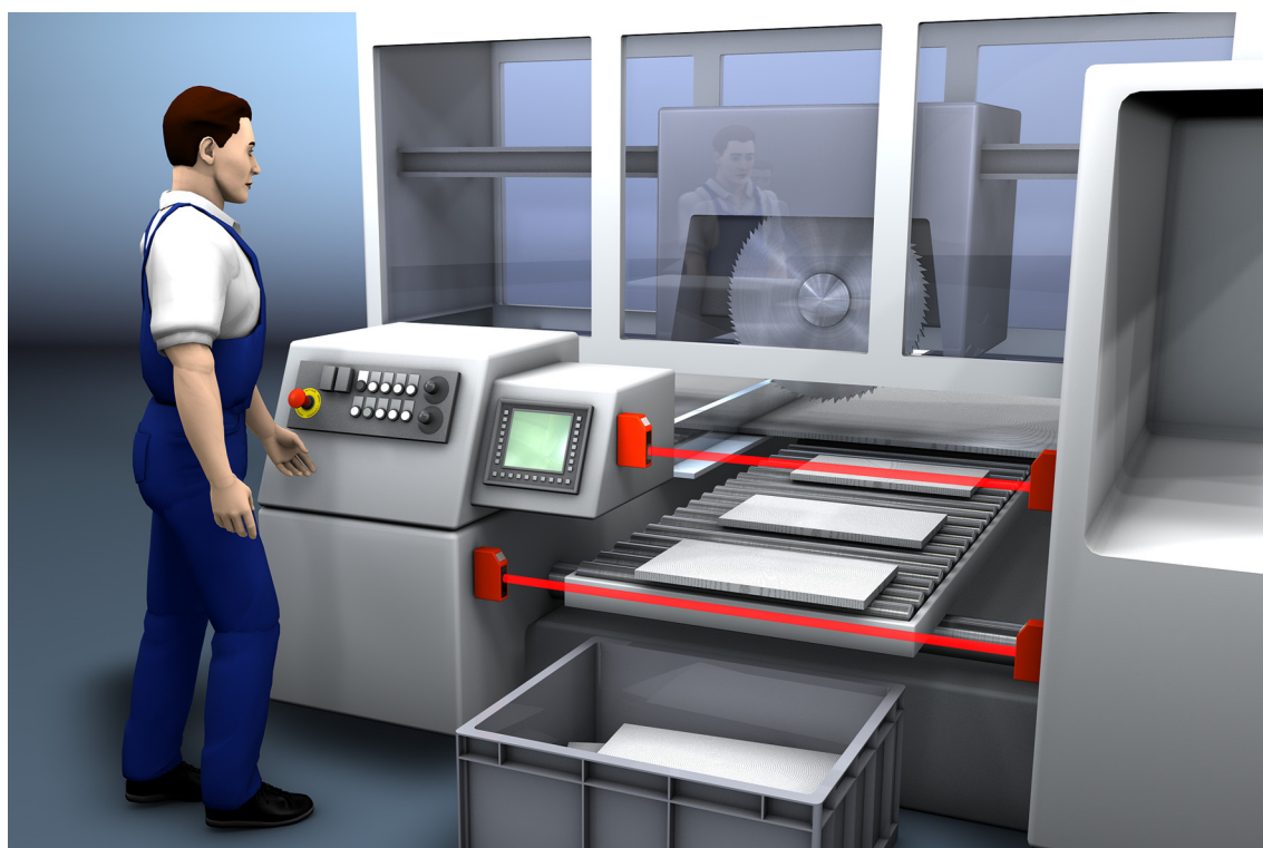
Figura 5.2: Protezione contro l'accesso/l'introduzione delle mani sulla segatrice
