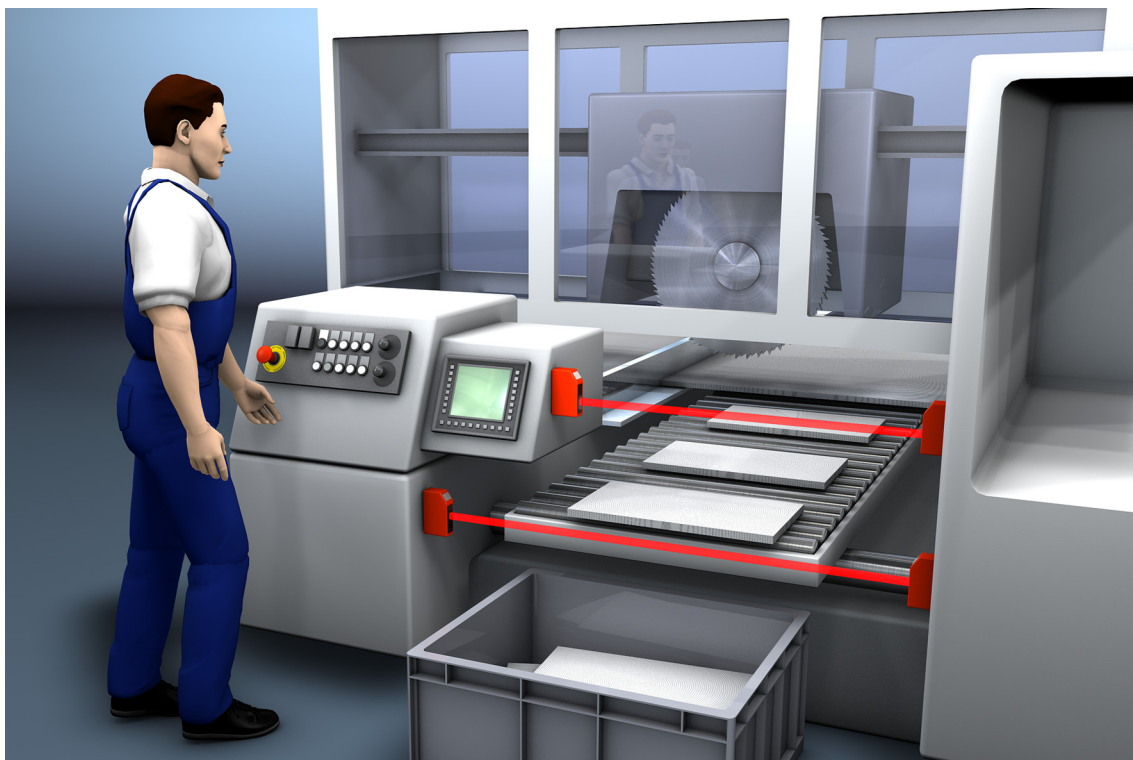
Fig. 5.2: Protección contra acceso/manipulación en la serradora
