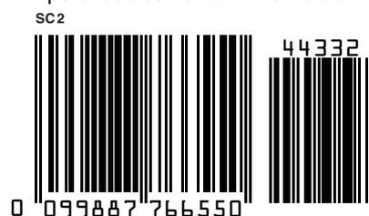
Figura 15.2: Modelli di etichette di codice a barre (modulo 0,5)
