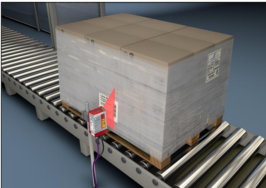
Figura 4.9: Principio di deflessione per lo scanner a linee
