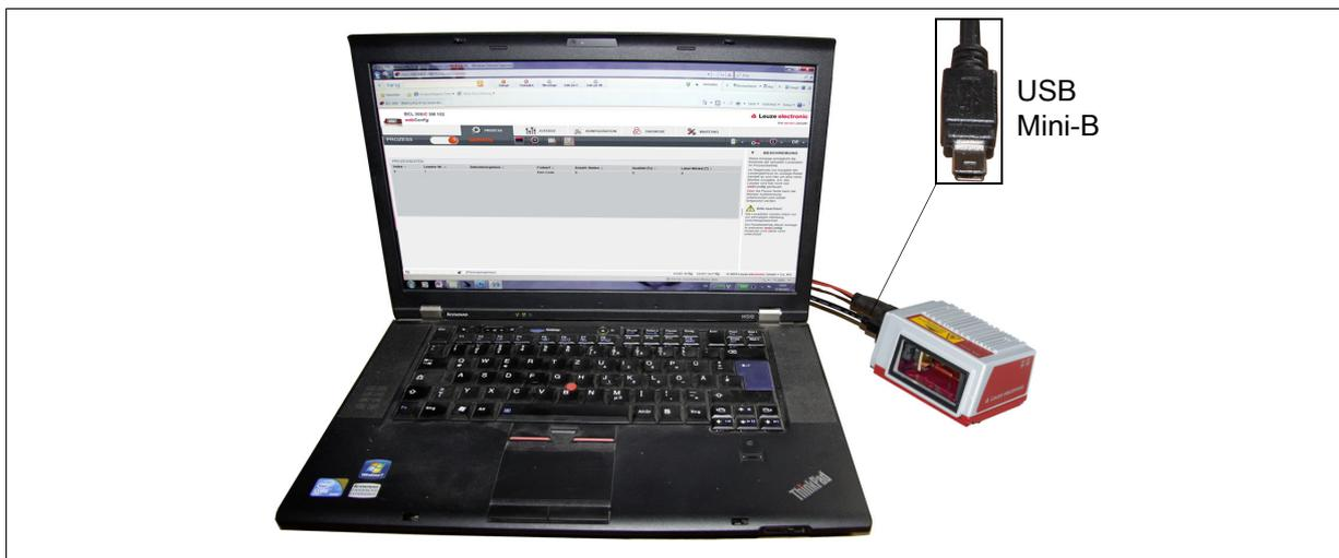
Figura 9.1: Collegamento dell'interfaccia USB DI ASSISTENZA
