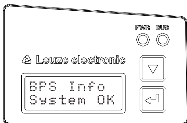
Fig. 10.2: Exemple : Information de statut de l'appareil/statut d'erreur à l'écran
