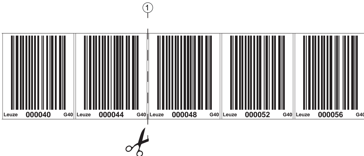
Fig. 6.1: Arête de coupe de la bande à codes à barres
