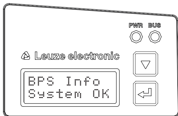
Bild 10.2: Beispiel: Gerätestatus-/Fehlerstatus-Information am Display
