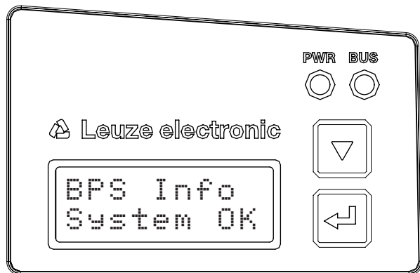
Bild 10.2: Beispiel: Gerätestatus-/Fehlerstatus-Information am Display
