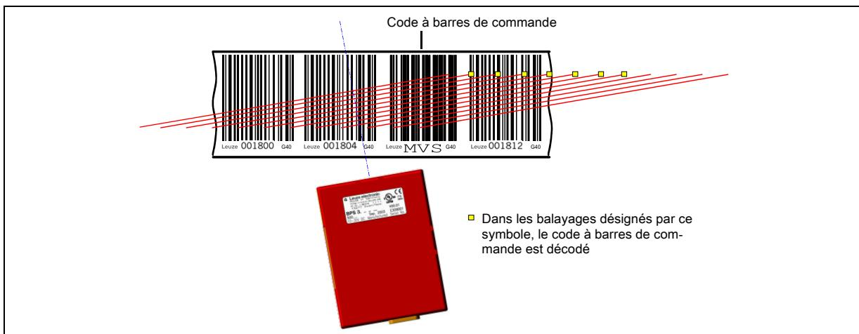
Figure 6.5 : Disposition des codes à barres de commande
