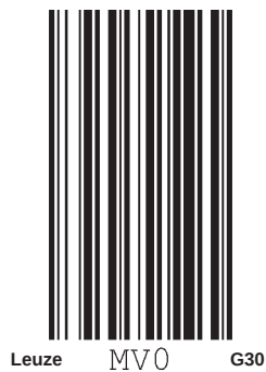
Figura 16.7: Etichetta singola MV0, reticolo da 30 mm
