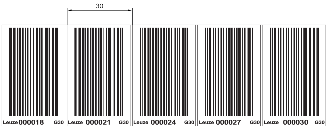
Fig. 11.2: Verificação do resultado de impressão BCB G30 ... conjunto de reparo (grade de 30 mm)
