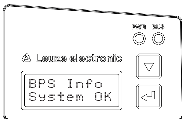
Bild 10.2: Beispiel: Gerätestatus-/Fehlerstatus-Information am Display
