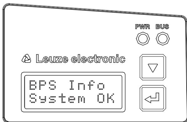
Fig. 10.2: Exemple : Information de statut de l'appareil/statut d'erreur à l'écran
