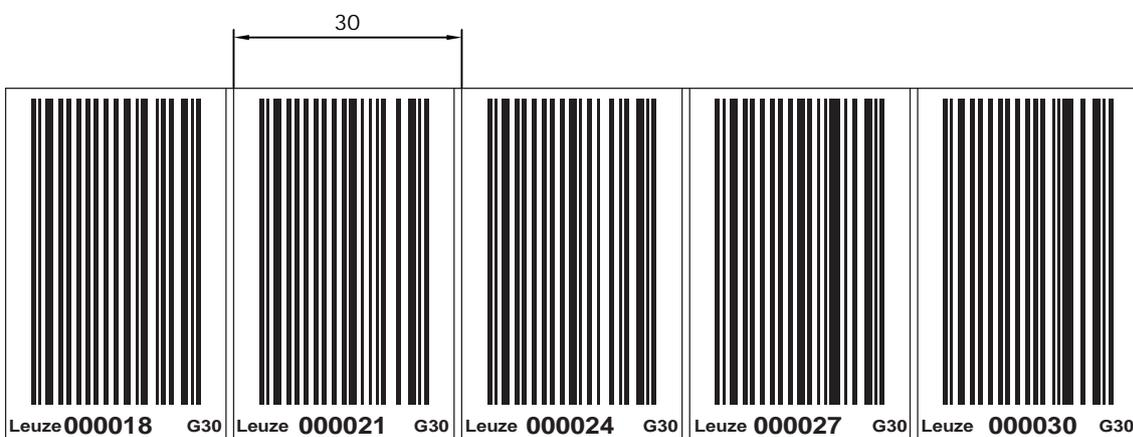
Figura 11.2: Comprobar el resultado de impresión del kit de reparación BCB G30 ... (raster de 30 mm)
