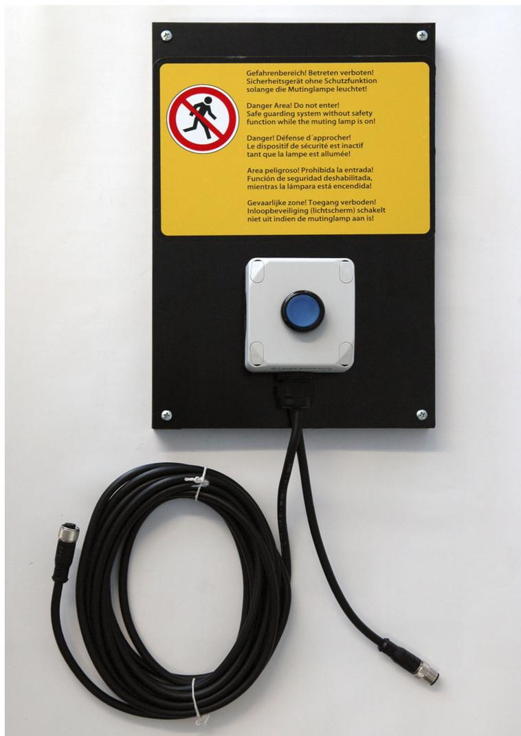
Figura 7.1: 426240 AC-ABF 70.BB; unità di conferma con tasto di Start illuminato, su piastra di montaggio con targhetta di avvertenza in 5 lingue, cavo di collegamento di 5 m
