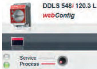
Figura 9.4: Commutazione del modo operativo (Processo - Assistenza)
