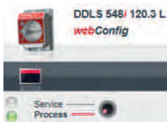
Figura 9.4: Conmutación del modo de trabajo (Proceso - Servicio)
