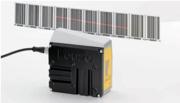
Das FBPS 600i arbeitet besonders zuverlässig. Mit jedem Scanvorgang werden mehrere Codes gelesen, aus denen die Software hochgenaue Positionswerte ermittelt. Durch den schrägen Verlauf des Scanstrahls und die Bewegung des Gerätes wird jeder Code an verschiedenen Stellen abgetastet. So werden Lesefehler durch lokale Verschmutzungen oder Beschädigungen vermieden.
