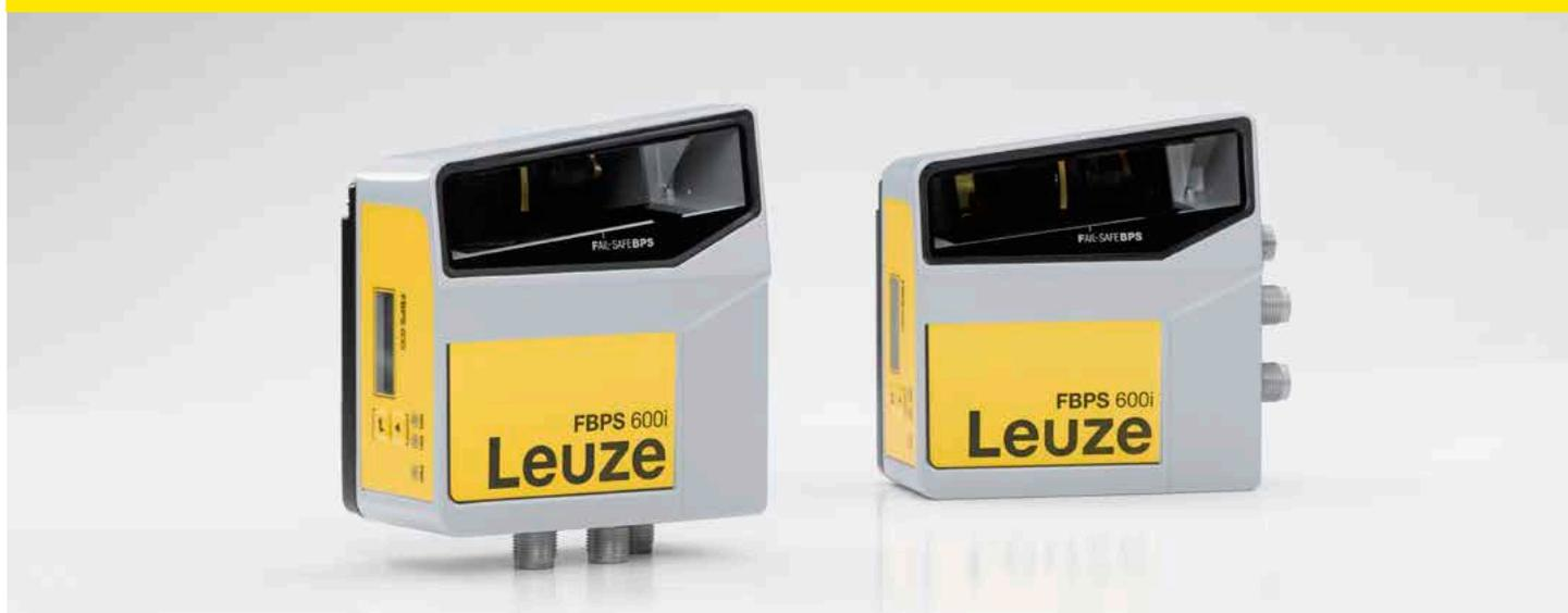
Mit dem weltweit ersten Sicherheits-Barcode-Positioniersystem FBPS 600i ist nur noch ein Sensor für die sichere Positionserfassung notwendig. Das Gerät wird über zwei SSI-Schnittstellen an eine sichere Auswerteeinheit - z.B. eines Frequenzumrichters - angeschlossen und ist für Anwendungen bis Performance Level e geeignet. So lassen sich Sicherheitsfunktionen besonders einfach umsetzen und der Aufwand bei Installation und Service wird reduziert.
