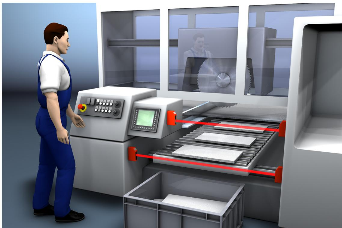
Figura 5.2: Protección contra acceso/manipulación en la serradora
