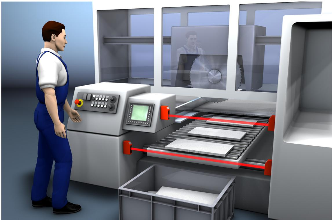
Bild 5.2: Zugangs-/Eingreifsicherung an Sägemaschine
