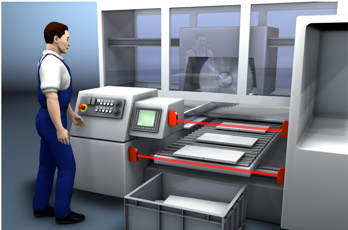
Bild 5.2: Zugangs-/Eingreifsicherung an Sägemaschine
