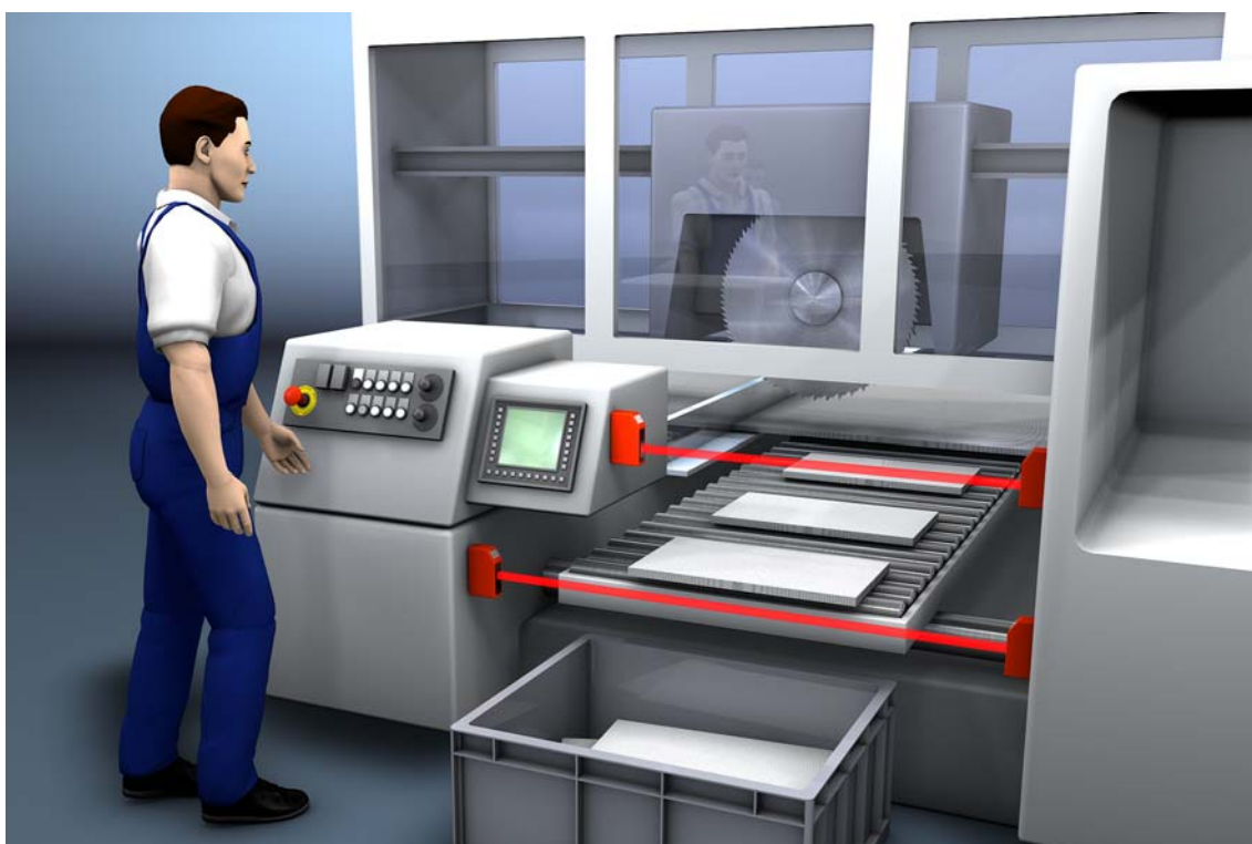
图 5.2: 锯木机通道保险装置 / 安全防护设备
