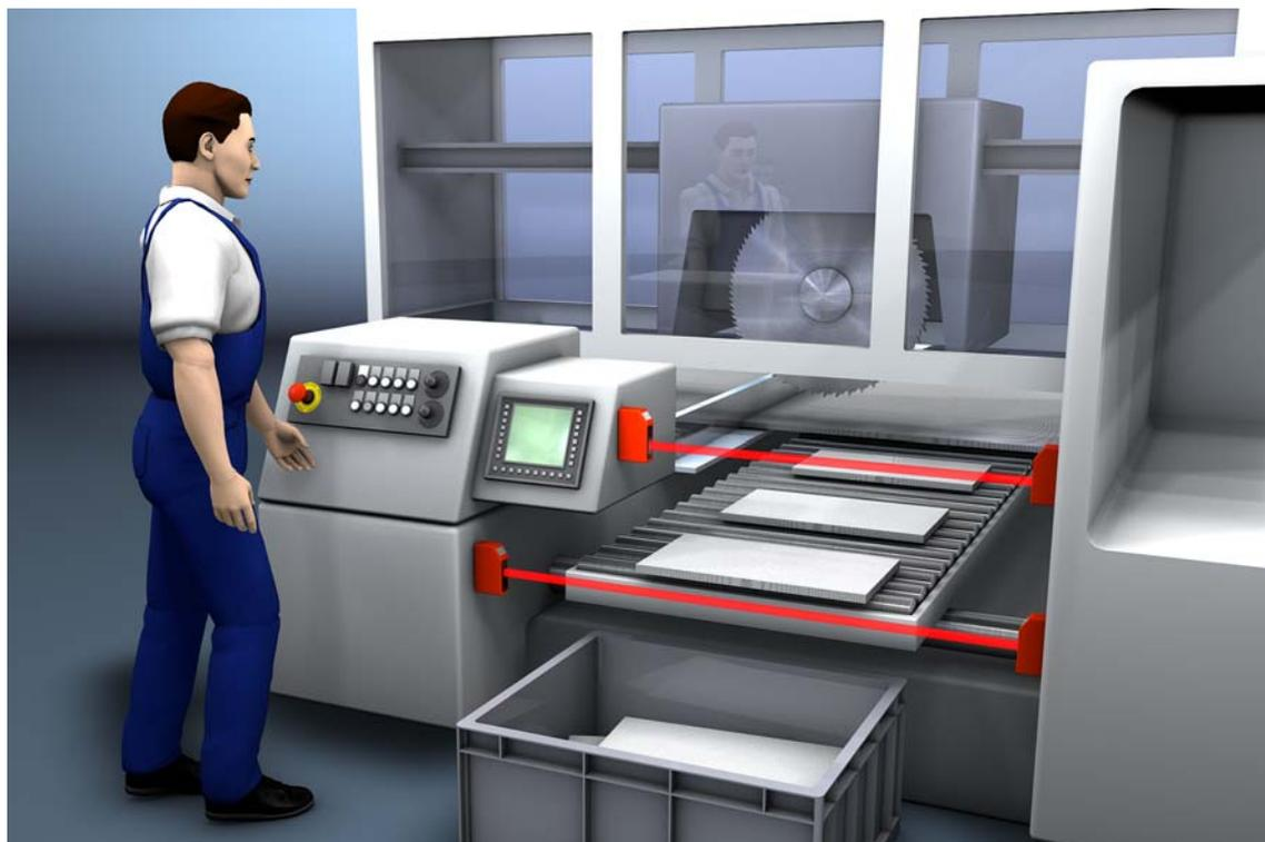
Figura 5.2: Protezione contro l'accesso/l'introduzione delle mani sulla segatrice
