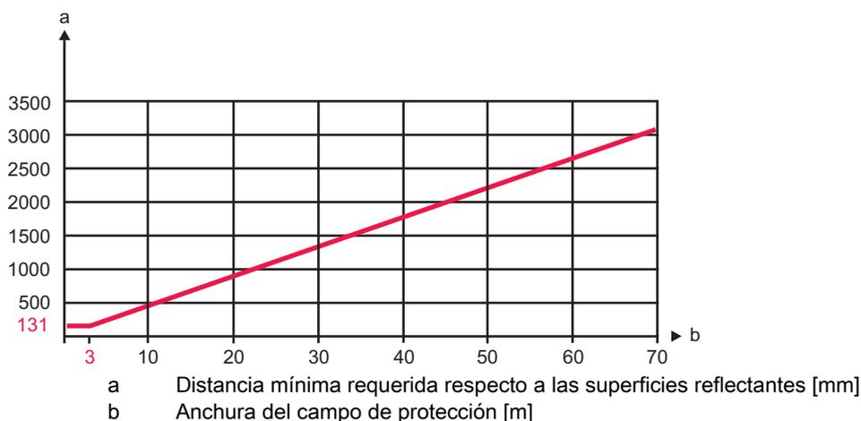
Fig. 6.4: Distancia mínima respecto a las superficies reflectantes en función de la anchura del campo de protección hasta 70 m
