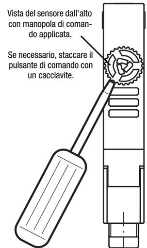
**Guida rapida alla regolazione del sensore mediante il tasto di apprendimento per GS 61/... (con apprendimento)**
