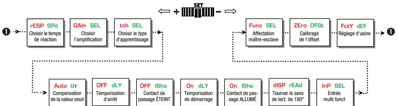
**Sélection d'une sous-fonction et modification du réglage**
