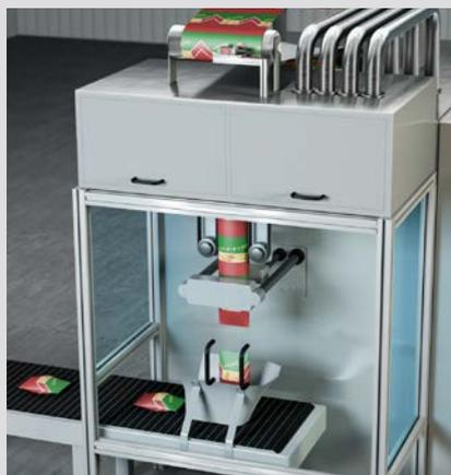
Zuverlässige Markenerkennung zum Schnitt von Sleeve-Etiketten
