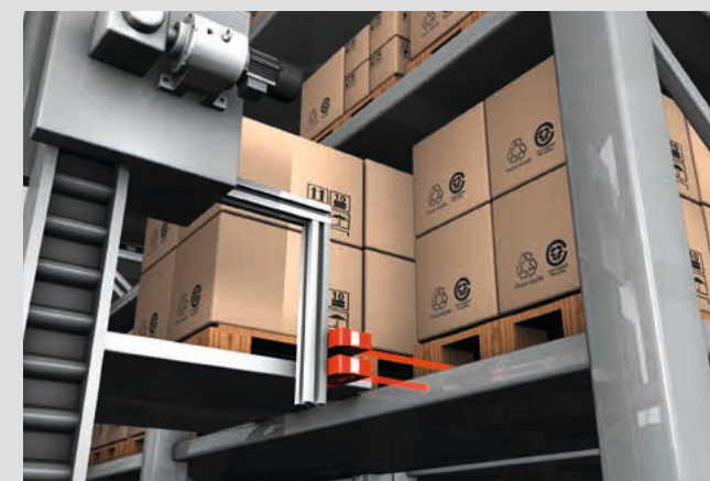
Fachfeinpositionierung im Hochregal
