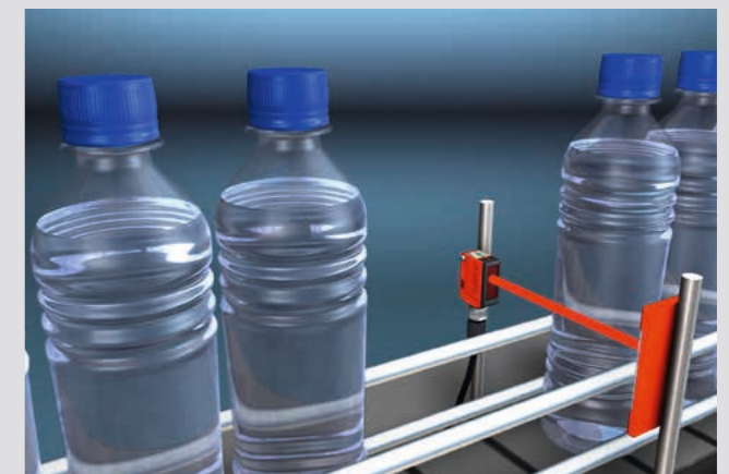
Detektion von PET- und Glasflaschen
