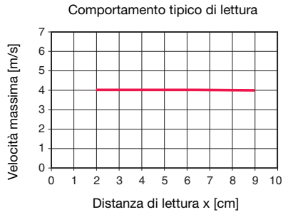
Figura 3.3: Comportamento tipico di lettura - Unità di lettura/scrittura RFM 32 Ex n
