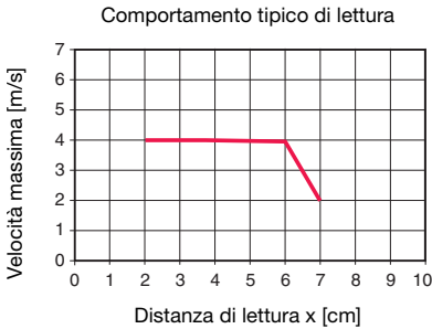
Figura 3.3: Comportamento tipico di lettura - Unità di lettura/scrittura RFM 32 Ex n
