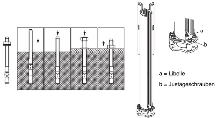
1. Die Geräte sind bereits in der UDC Gerätesäule montiert. Die Montagehöhe in der Säule kann durch Lösen der Inbus-Schrauben der Klemmhalterungen angepasst werden.
