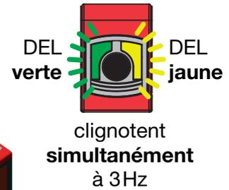
**Verrouillage de la touche d'apprentissage par l'entrée d'apprentissage**
