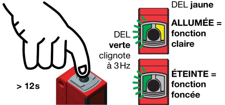
**Verrouillage de la touche d'apprentissage par l'entrée d'apprentissage**
