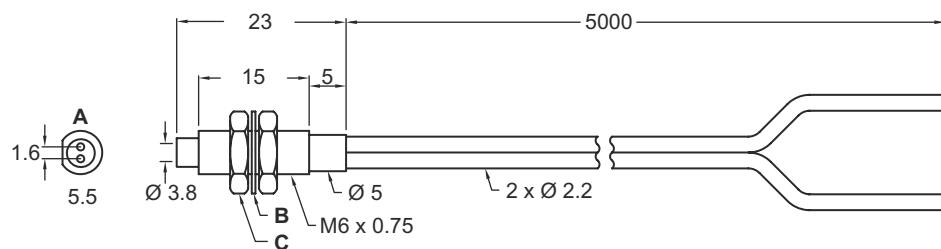
A Ø 1,0 mm núcleo de fibra de vidro x 2 pç.
