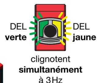
**Apprentissage pour une sensibilité du capteur de 18% (bouteilles standard)**
